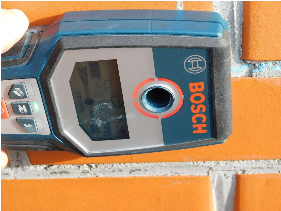
Fot nr 55. Detekcja łączników na poziomie 3 piętra klatka 5
